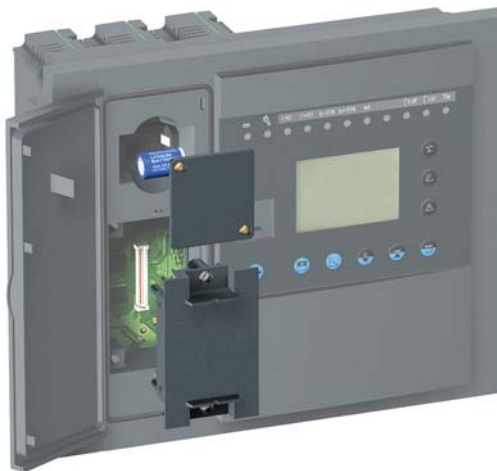
Картридж памяти, устанавливаемый на передней панели
