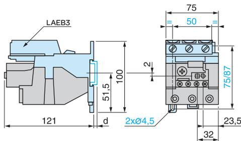
Монтаж на DIN-рейке AM1D●●●
