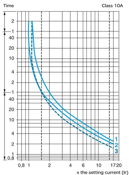
1. Симметричная 3-фазная нагрузка, без предварительного протекания тока (из «холодного» состояния).
