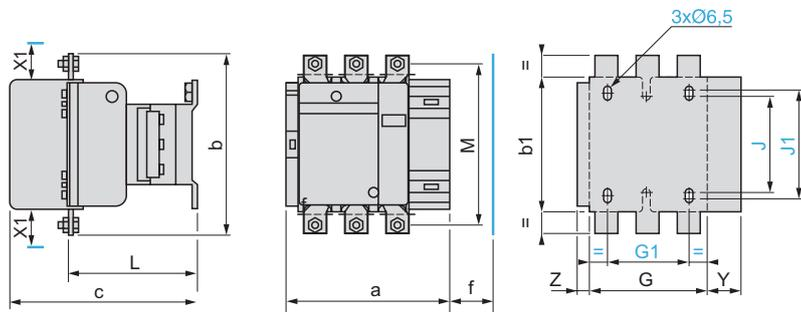
X1 (мм) = минимальное электрически безопасное расстояние в зависимости от рабочего напряжения и отключающей способности.
