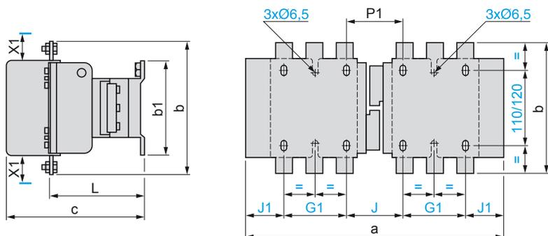
X1 (мм) = минимальное электрически безопасное расстояние в зависимости от рабочего напряжения и отключающей способности.
